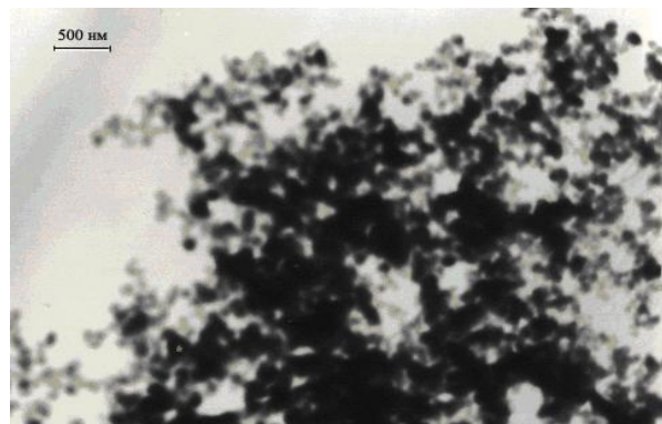
Рис. 1. Микрофотографии частиц серебра, полученных в эквимолярных соотношениях нитрата серебра и таннина
