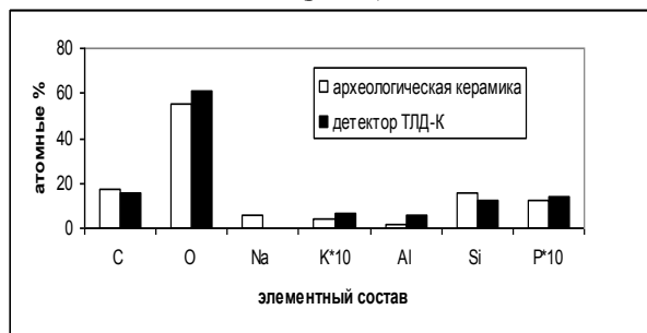
Рис. 5. Сравнение элементного состава археологической керамики и детекторов ТЛД-К
