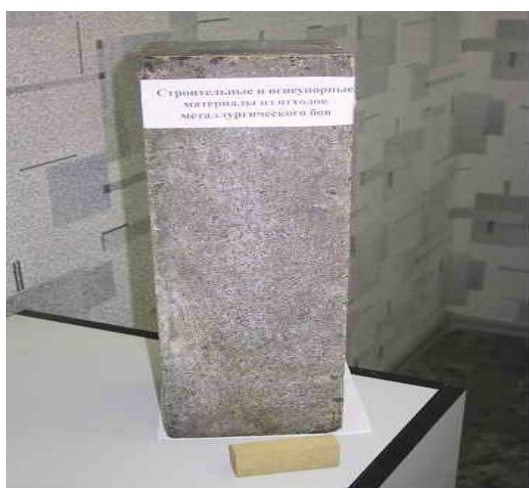
Рис. 2. Кирпич из огнеупорного боя (шамот)
