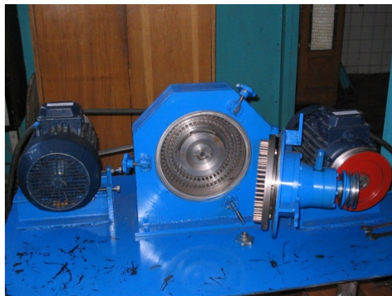
Рис. 1. Дезинтегратор производительностью 150 кг/час. Мельница шаровая центробежно-эллиптическая ЦЭМ-7
