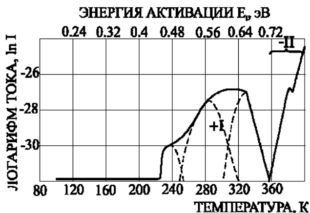
Рис. 3. Температурная зависимость тока ТРК в НК \beta -азиде свинца при положительном потенциале на НК. Скорость нагрева 0,28 К/с
