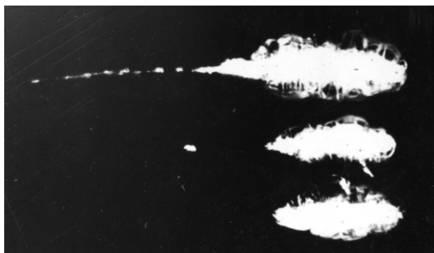
Рис. 4. Следы разрушений в плавленом кварце. На верхней части – типичное самоискривление лазерного излучения. Размер по горизонтали – 1,6 см. Публикуется впервые
