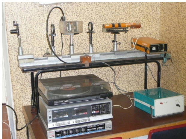
Рис. 7. Установка для передачи музыки по лазерному лучу
