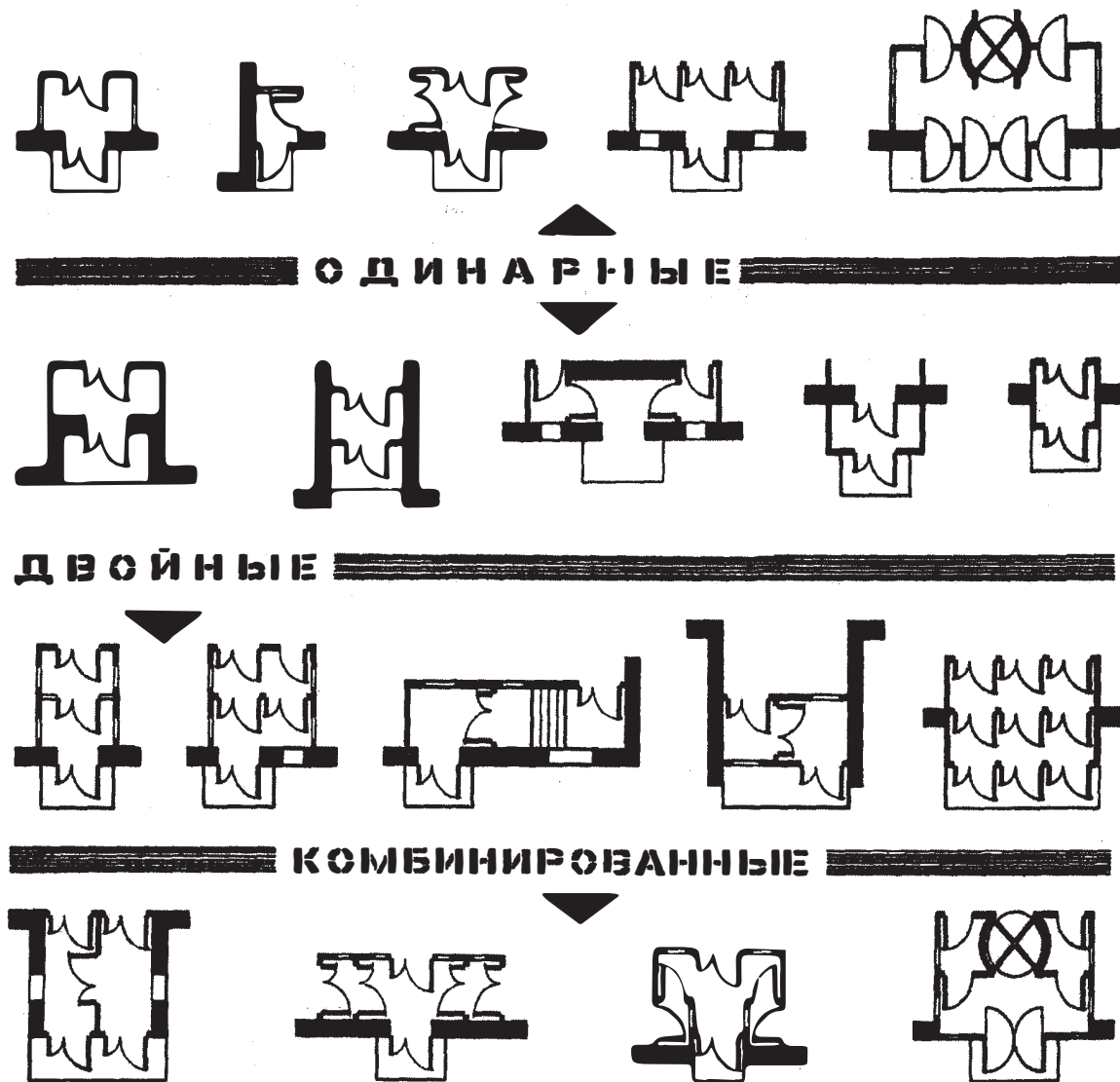
Рис. 9. Тамбуры входных узлов жилых зданий
