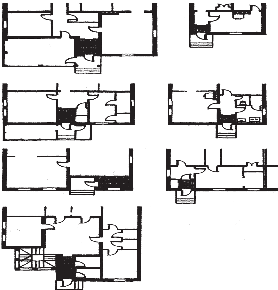
Рис. 1. Планировочные схемы входных узлов малоэтажных жилых зданий
