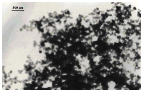
Рис. 1. Микрофотографии частиц серебра, полученных в эквимольных соотношениях нитрата серебра и таннина
