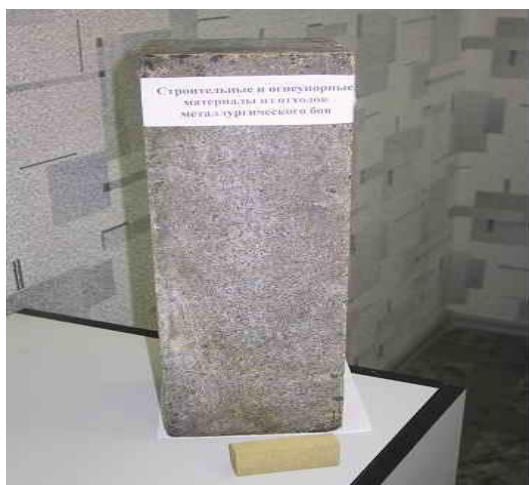
Рис. 2. Кирпич из огнеупорного боя (шамот)
