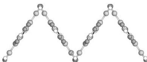
Рис. 3. Пространственное расположение молекул кроконовой кислоты, показывающее структуру типа «аккордеон»
